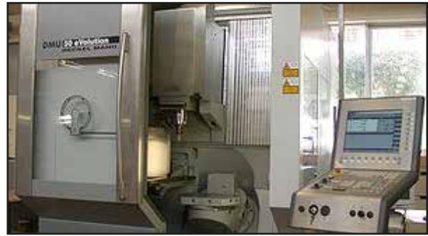
Máquina fresadora con control numérico por computadora CNC
